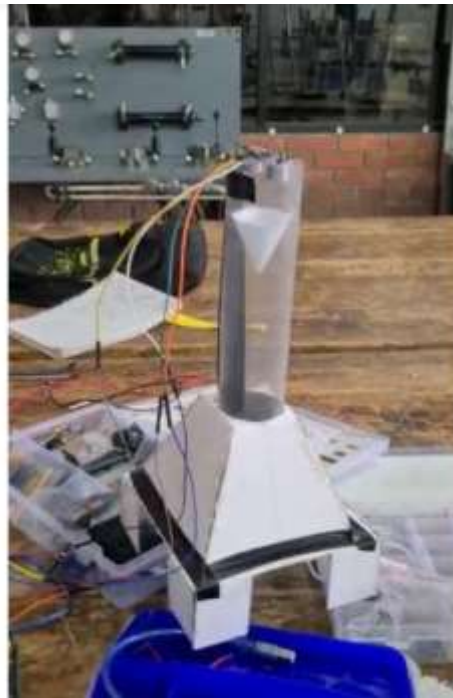
Figura 5. Prototipo del túnel de viento.
