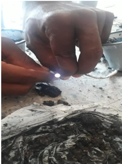
5. Led blanco encendido con batería de tierra
