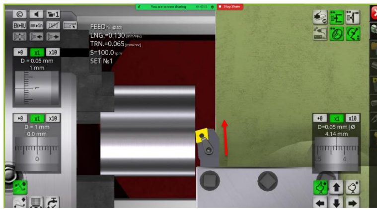
Figura 4: Refrentado posición final en el Simulador
