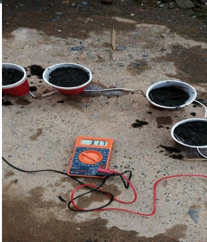
Configuración batería de tierra 4 puntos
