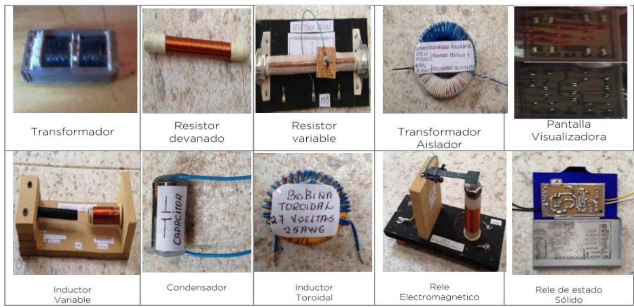
Figura 3. Componentes elaborados por los estudiantes de Tecnología electrónica,
