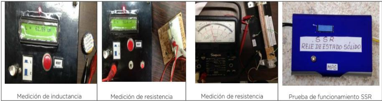
Figura 4. Protocolo de pruebas para la validación del componente elaborado.
